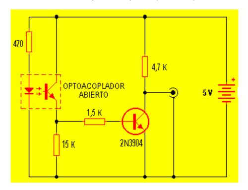
Es ideal para ser empleado con conjuntos de foto-diodo foto-transistor abiertos como los empleados en los codificadores de los mouses.
